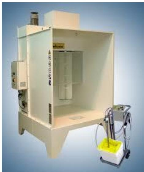
**2. Plastifikacija** – Čisti i odmašćeni metalni predmeti smjeste se u ventiliranu kabinu za plastifikaciju te se elektrostatskim pištoljem nanose slojevi negativno nabijenih čestica praha na uzemljene predmete koji su pozitivno nabijeni te se pažljivo transportiraju do peći za polimerizaciju.
